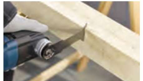
Ⓒ柱のほぞ切り
