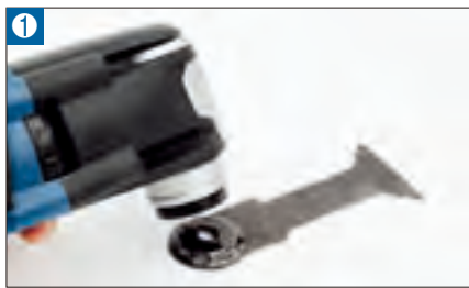
マルチツール本体とブレードを用意します。
